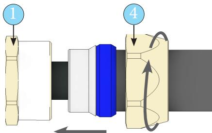
**Step 3** Insert part (2) inside the corrugated conduit and open the bushing (5) place the corrugated conduit and close. Hand tighten between body and nut (1 and 4). Retighten the final system./ Inserire la parte (2) all'interno del tubo corrugato e aprire la boccola (5) posizionare il tubo corrugato e chiudere. Serrare a mano tra corpo e dado (1 e 4). Serrare il sistema finale.
